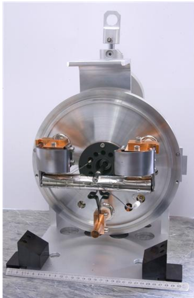
Figura 2.3: Fotografía de un blanco de carburo de uranio. Dicho material está contenido en el cilindro central en posición horizontal sobre el que se hace incidir el haz de protones longitudinalmente siendo la producción extaída transversalmente por el centro de la estructura [33].
