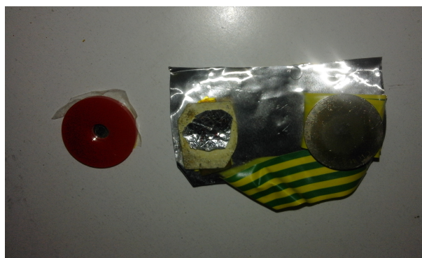
Figura 4.4: Fuentes de partículas alfa utilizadas en el trabajo. ^{210}\text{Po} izquierda, ^{148}\text{Gd} centro y triple alfa derecha.
