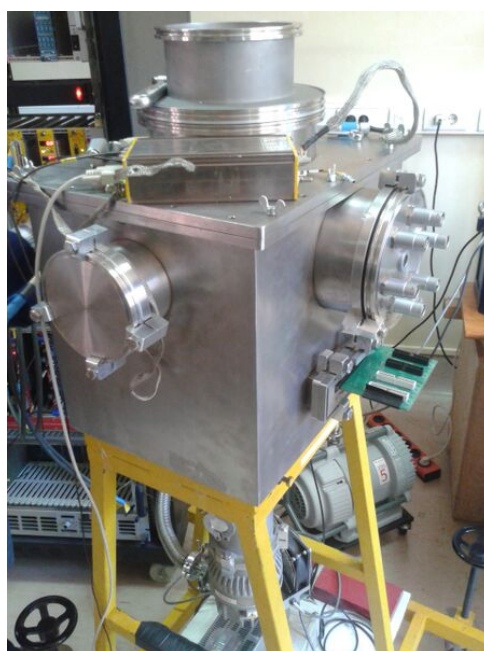
Figura 4.3: Sistema de vacío para las medidas de la capa inerte. Se pueden ver la cámara de vacío, la bomba turbo-molecular conectada a ella (debajo de la cámara) y la bomba previa (en el suelo)
