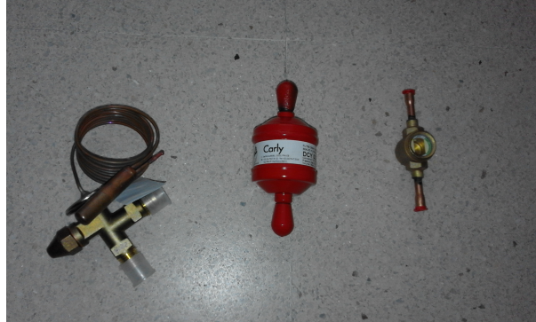
Figura B.2: Dispositivos extra para el circuito del refrigerador. De izquierda a derecha válvula de presión, filtro anti-ácido y sensor de humedad.
