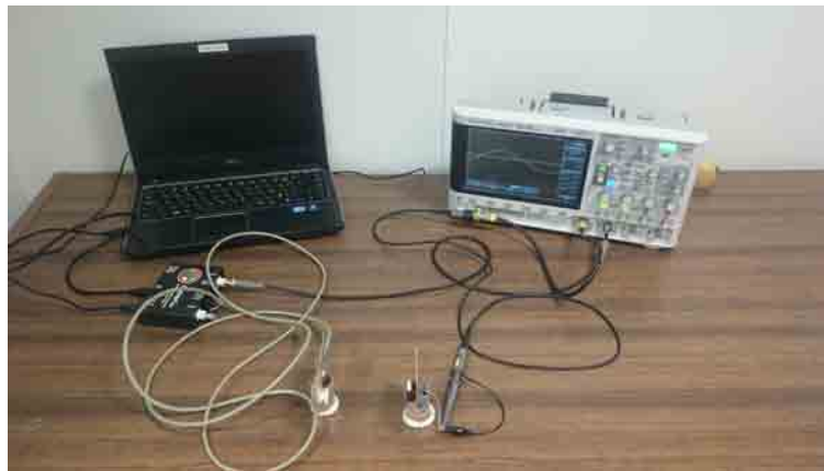
Gráfica 16: Montaje para medición de las características físicas del plomo
