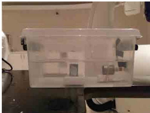
Gráfica 57: Disposición del transductor de 200kHz con el plomo.
